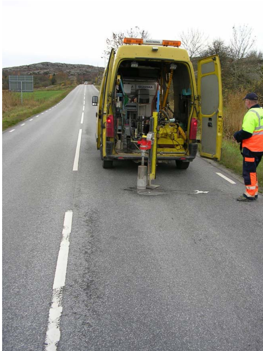
Bild B1.3a visar ett sämre parti med bruksförlust och stensläpp. Borrprov för undersökning av finmaterial i vändskak togs mellan hjulspår för att få "opåverkat" material
