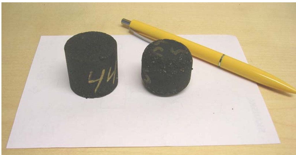
Figur 3. Provkropp före respektive efter körning i vändskaksutrustning. Den högra provkroppen visar ca 25% slitage, vilket i en förprovning motsvarar mastixmaterial med viss risk för beständighetsproblem.
